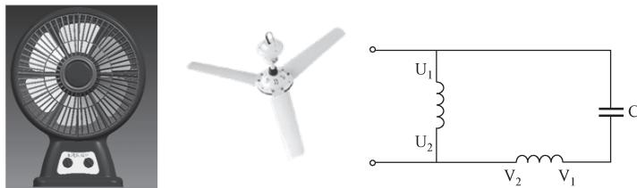
图 5-19 家用风扇的等效电路
