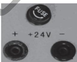
图 1-17 直流电源插孔
